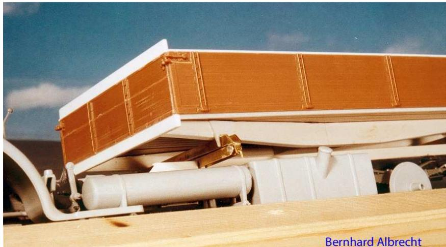
dritten Bordwandscharnier (von in Fahrtrichtung vorne gesehen), der zweite Sägeschnitt vor dem vierten Bordwandscharnier. Das dritte Bordwandscharnier mitsamt der mittleren Bordwandrunge wurde entfernt. Übrig blieben somit ein Bordwandteil mit zwei Scharnieren und eins mit dreien. Zusammengeklebt wurde daraus eine einzelne lange Bordwand mit fünf Scharnieren.
