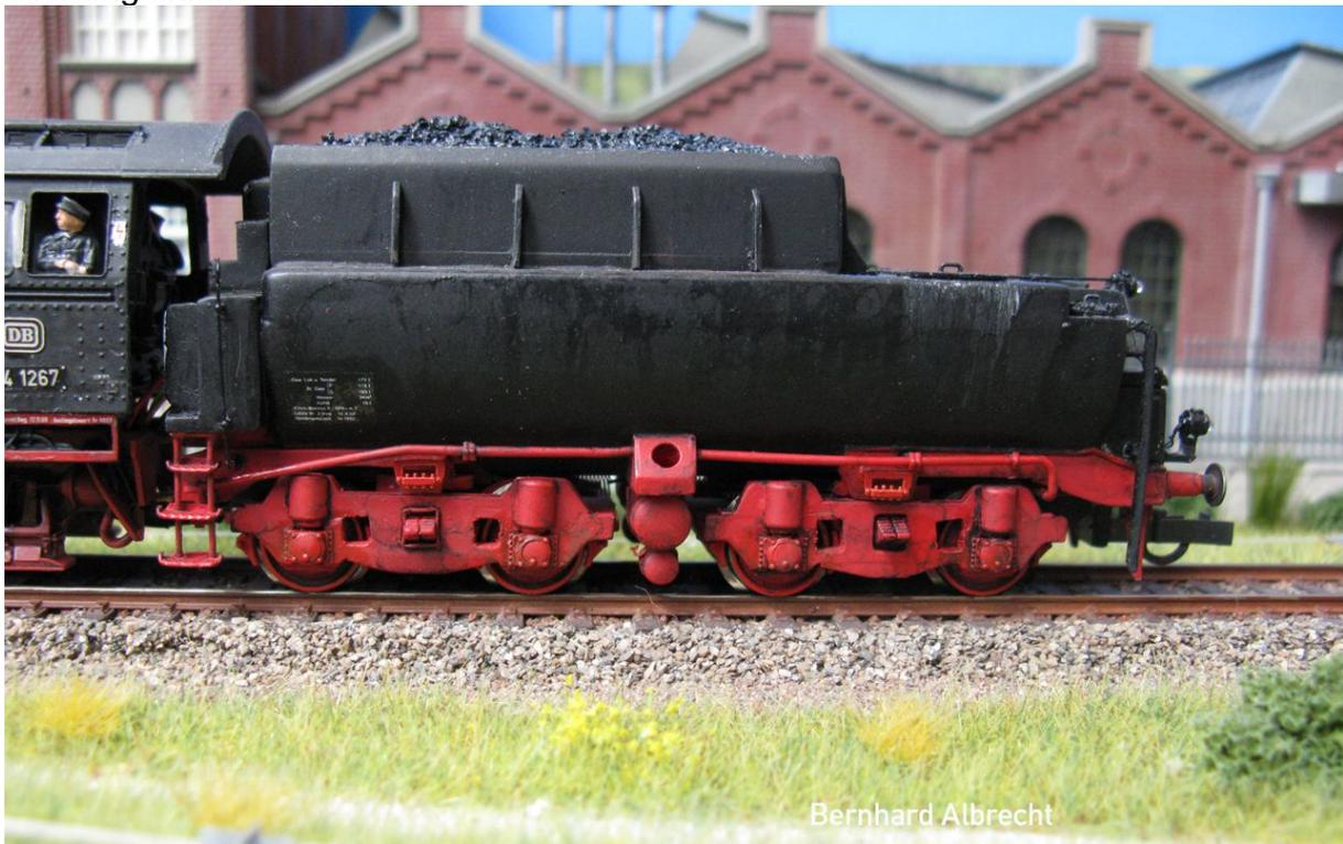
Für das Fahrwerk hatte ich zunächst die zweiachsigen Drehgestelle des Märklin-Wannentenders vorgesehen. Die Kupplungen sollten samt den Kulissen ebenfalls aus dem Serientender der Trix-Lok ausgeschnitten und im neuen Tender verwendet werden.
